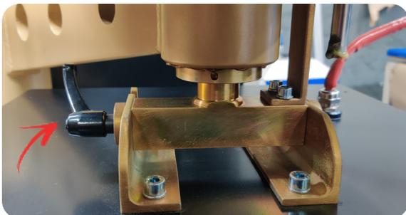
4. Retire el aire comprimido y mueva el cilindro hacia abajo;
